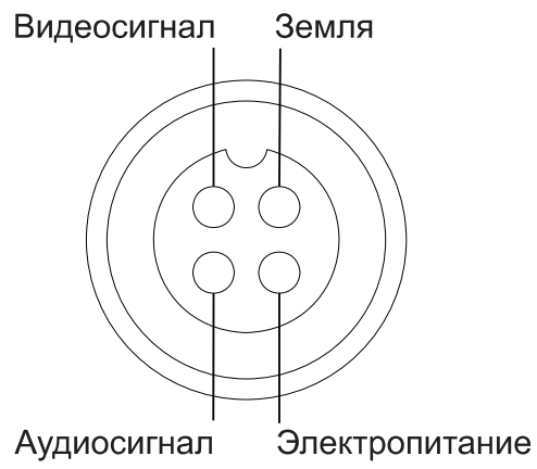
Рис. 1.2. Назначение контактов авиационного разъема
