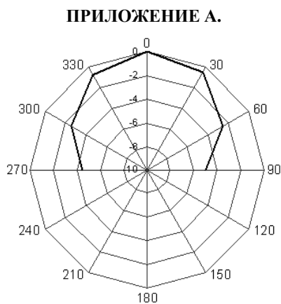
Рисунок 1. Диаграмма направленности звука ЭКРАН-а-С3.
