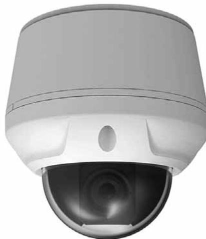
Телекамера STC-3913 помещена в вандалозащищенный алюминиевый корпус со степенью пыле- и влагозащиты IP66. Благодаря встроенному обогревателю камера стабильно работает в диапазоне температур от -40° до +50°С. Дополнительный кронштейн STB-C104 дает возможность монтажа камеры на стену. Модуль камеры оснащен 12-кратным трансфокатором, который дополняется функцией 16-кратного цифрового увеличения.
