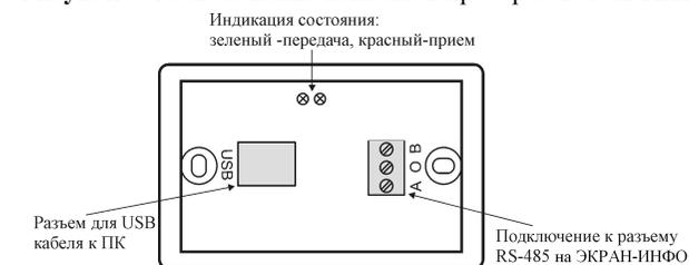
**Рисунок 7.** Расположение разъемов преобразователя ПИ2.
