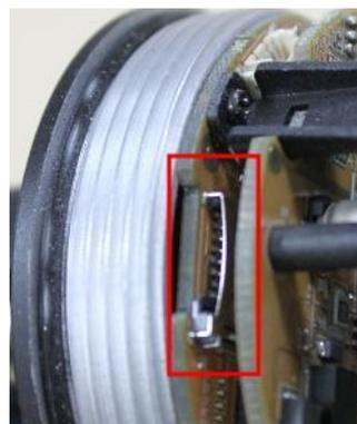
Фокус линзы может быть скорректирован. Отвинтите переднюю крышку, извлеките резиновую оправу объектива, ослабьте винт в основании линзы и затем поворачивайте линзу, чтобы скорректировать фокус.
